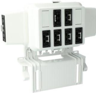
**Enfichable 100 %, boîtier AK2, WAGO WINSTA® MIDI, entrée : 5 pôles noirs, sortie : 2x 3 pôles noirs par sortie, L1/L2/L3, incl. plaque de montage soudée**
