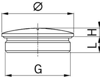
**Bouchon d'obturation laiton**
