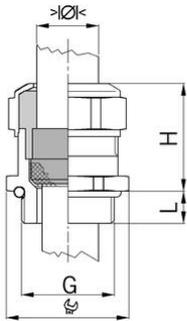
**Kurzes Anschlussgewinde Pg**
