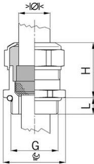
**Kurzes Anschlussgewinde Pg**
